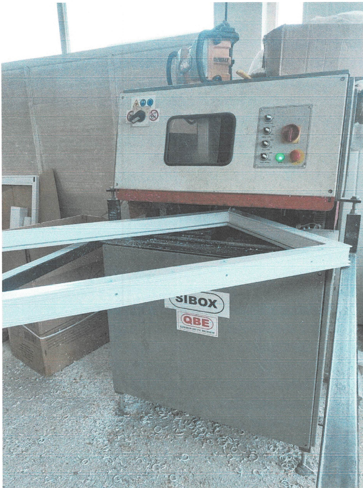
CISCENJE IVICA ZAVARENOG PVC PROFILA
