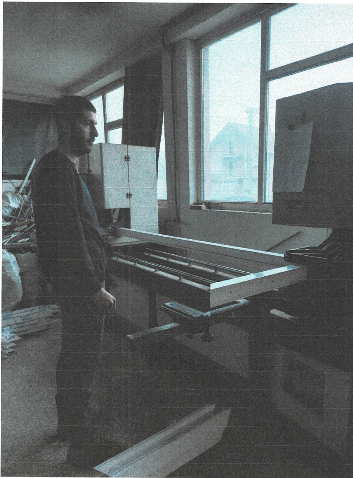
VARENJE - SPAJANJE PVC PROFILA
