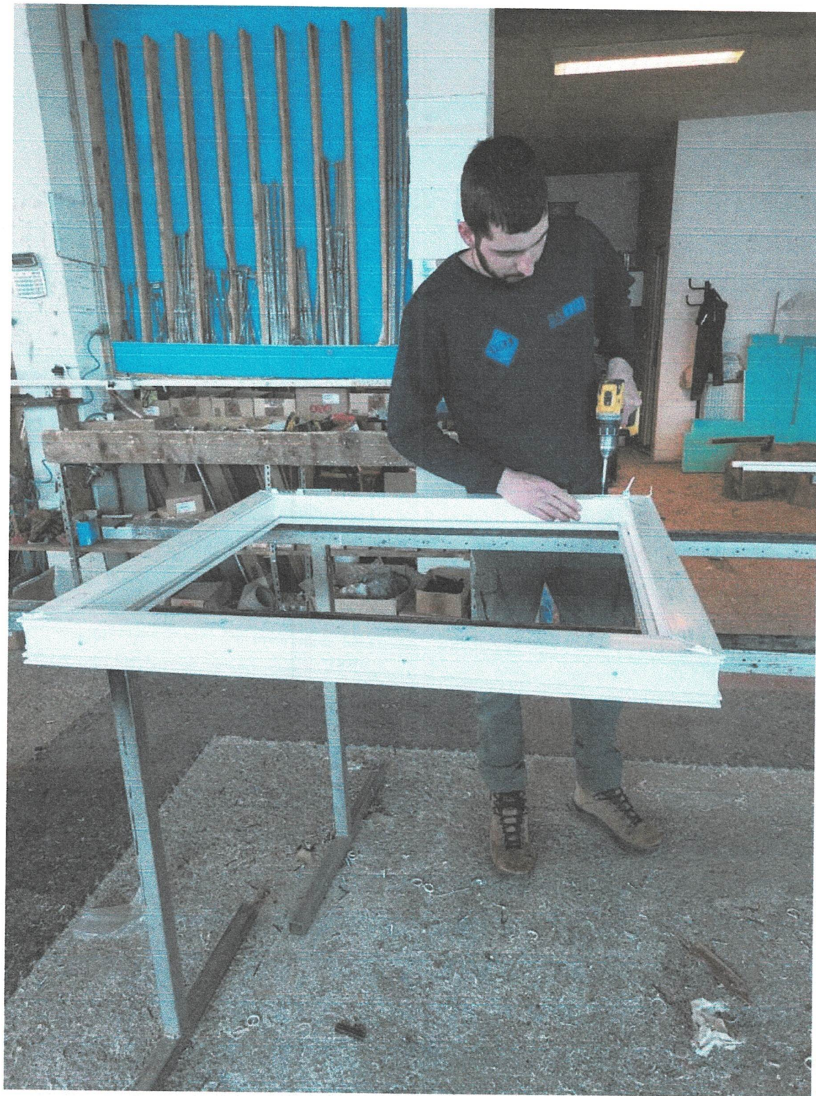
MONTIRANJE OKOVA - SPAJANJE RAMA I KRILA
