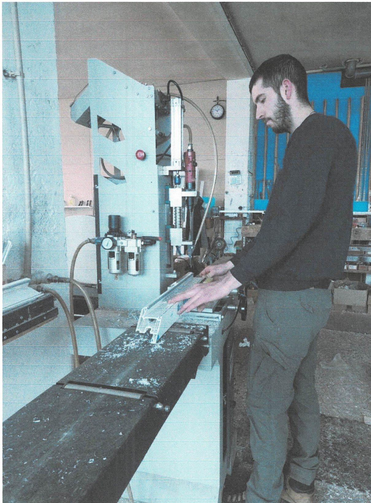
SRAFLJENJE - SPAJANJE METALNOG OJACANJA I PVC PROFILA
