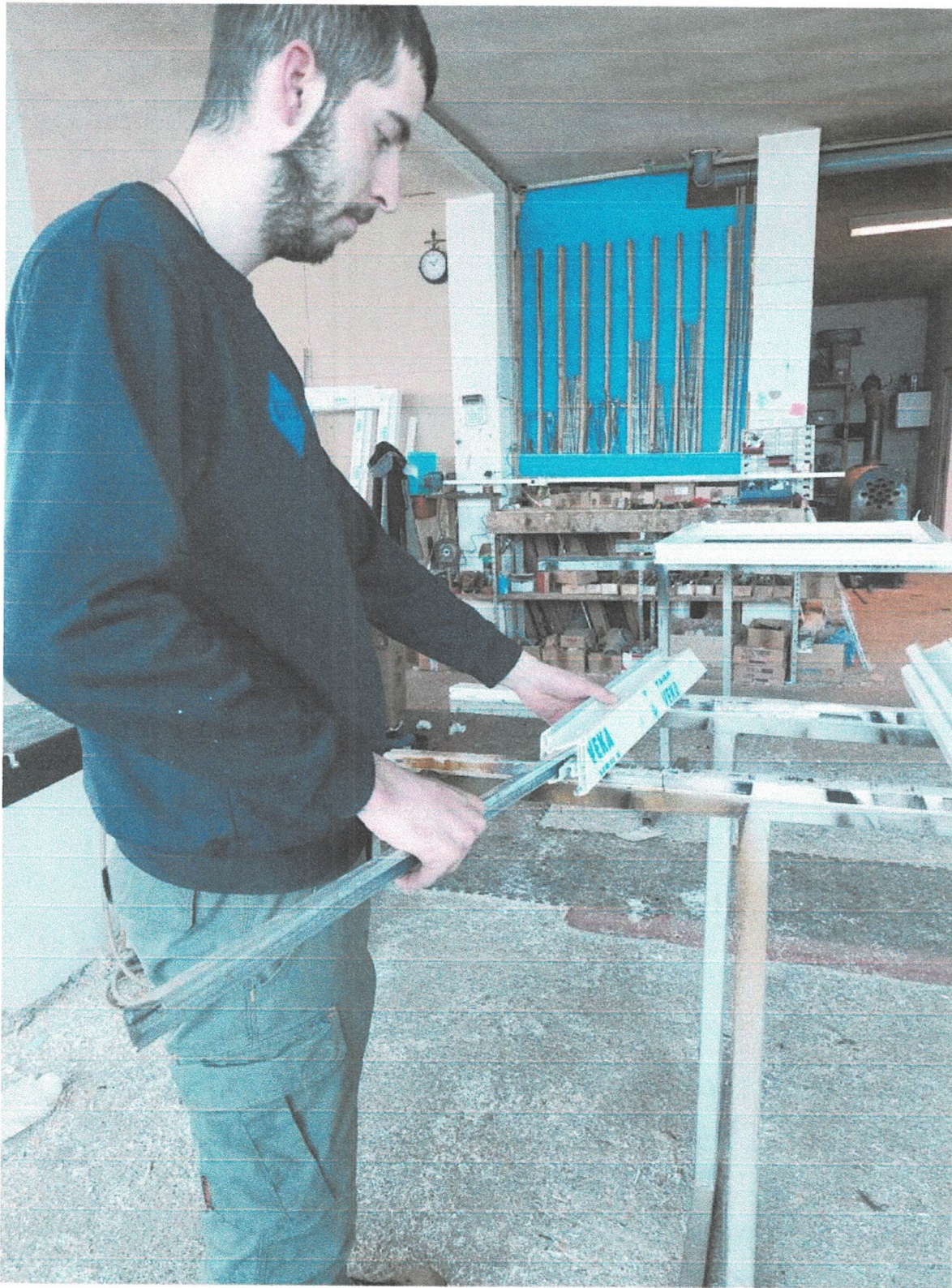
UBACIVANJE METALNOG OJACANJA U PVC PROFIL
