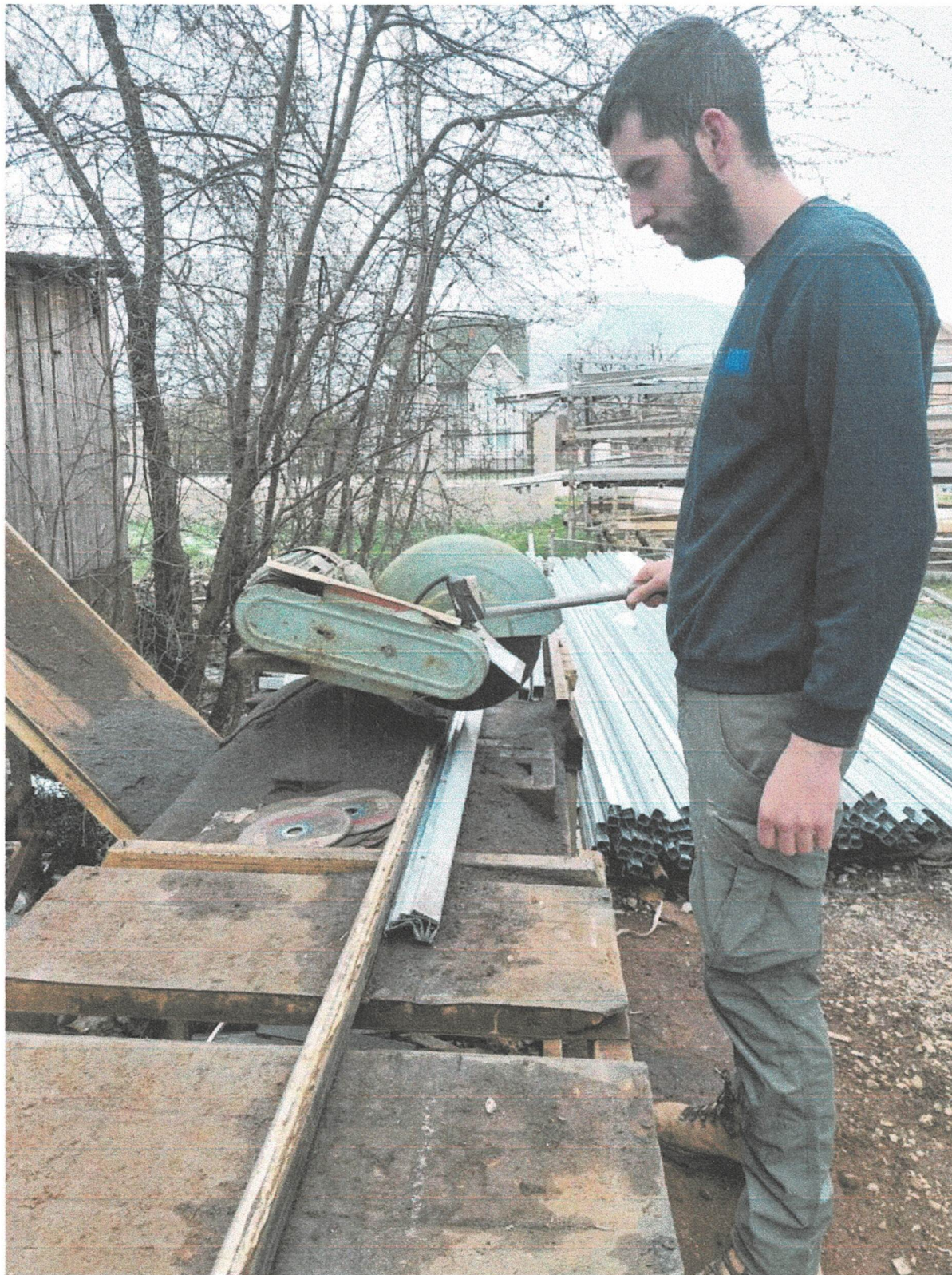
REZANJE METALNOG OJACANJA ZA PVC PROFILE
