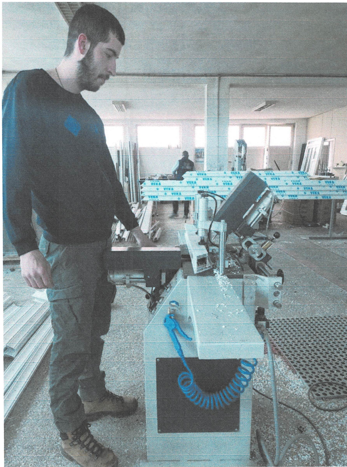
BUSENJE RUPA ZA ODVODNE KANALE I RUCKE
